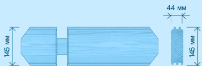
44×145 мм — оптимальный размер бруса для сборки небольших построек
